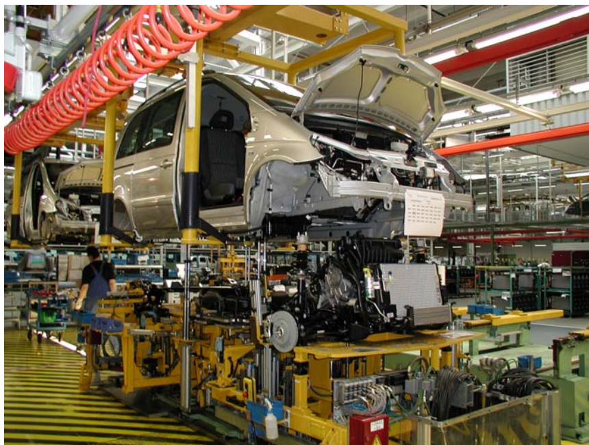
Fig. 3: Apparecchiatura di montaggio controllata da convertitori (periodo aureo Vaneo)
