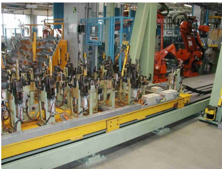
Fig. 1:- Linea di produzione della scocca con celle di saldatura robotizzate (in secondo piano) e slitte di trasporto per il caricamento (Vaneo) controllate da convertitori
