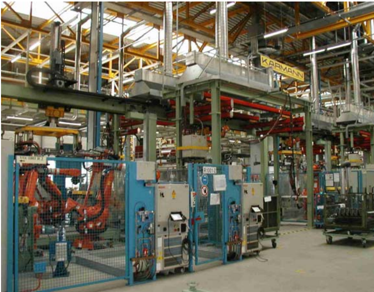
Fig. 5: Convertitore a portale per il collegamento delle celle di saldatura robotizzate nella produzione della scocca con un dettaglio del quadro elettrico
