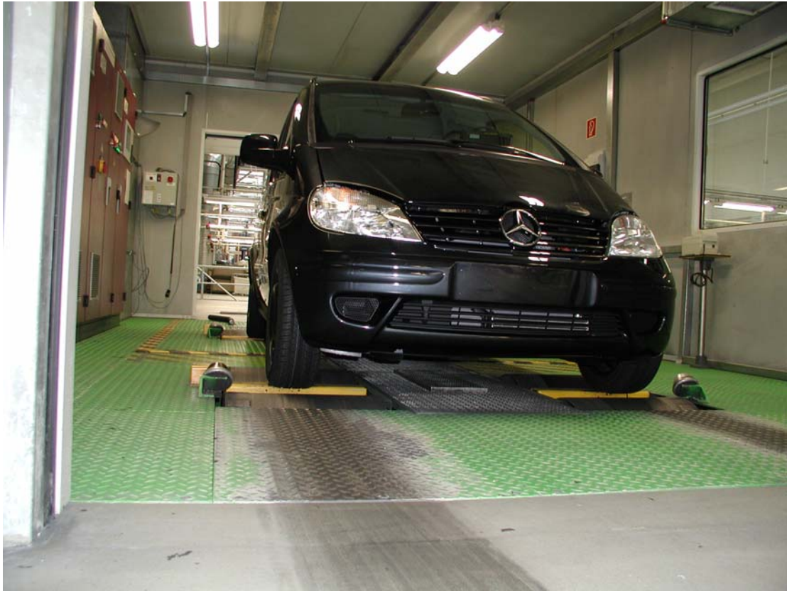
Fig. 7: Banco di prova a rulli azionato da convertitore Unidrive
