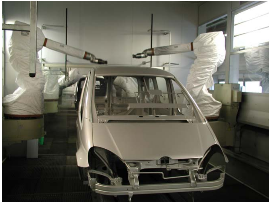
Fig. 2: Dettaglio del reparto verniciatura (Vaneo) – L'alimentazione e lo scarico dell'aria sono controllati da convertitori
