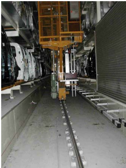
Fig. 6: "KAROLA" – Torre di alimentazione nel reparto verniciatura con quadro di azionamento
